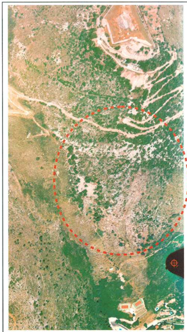
Photographie 10. Extrait de photographie aérienne, Zone de chutes de pierres et de blocs au sud du sommet du Mont Chauve.
